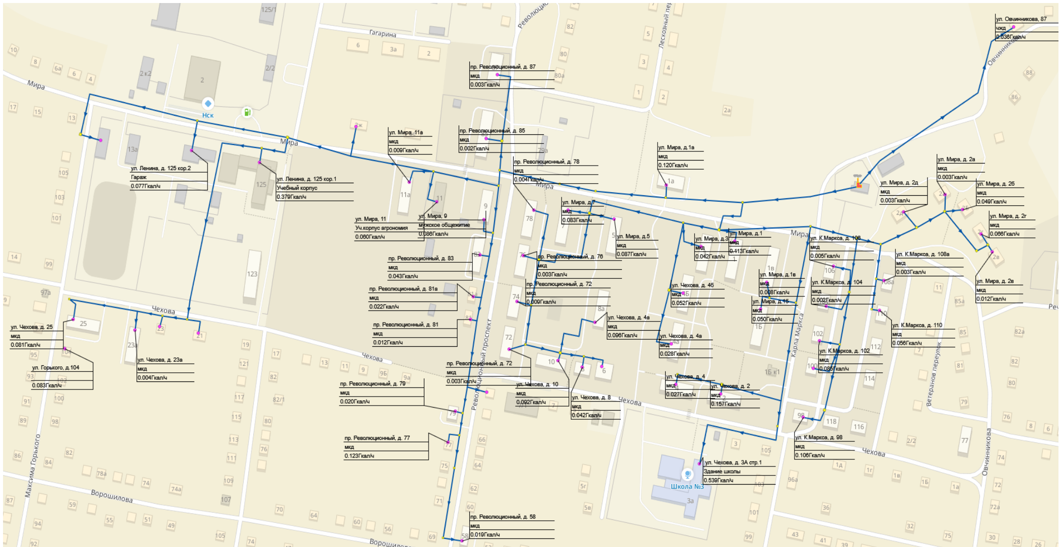
Рисунок 6. Схема тепловых сетей от Котельной «Черемушки»
